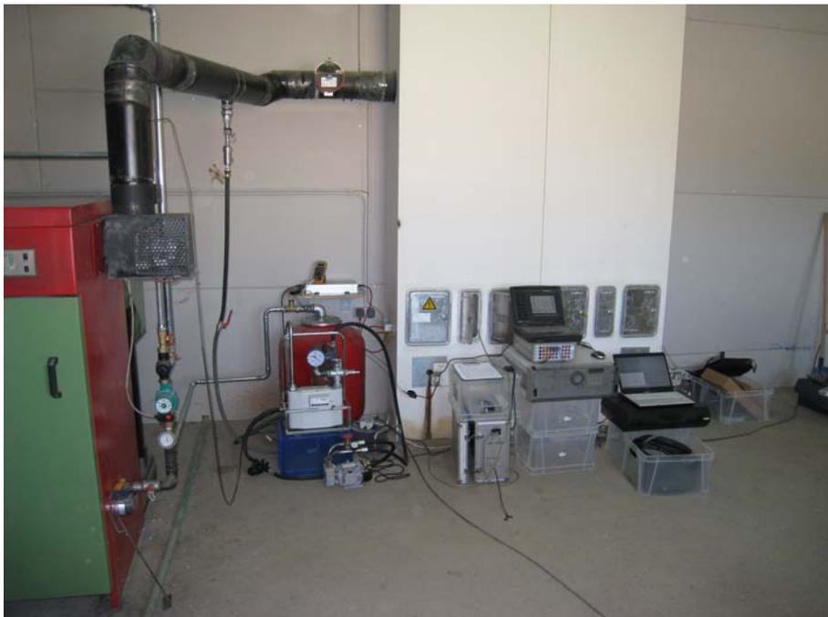
Abbildung 3-1: Messanordnung bei der Feuerungsanlage
