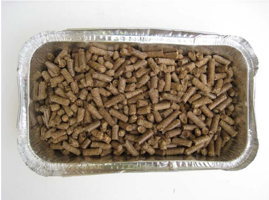
Abbildung 2-2: Brennstoff Heupellets
